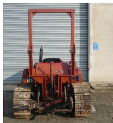
Figura 13. Struttura di protezione per trattori a cingoli modello Fiat 765 C e simili (Fiat 665 CM)
